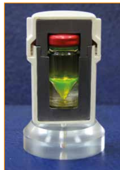
Przekrój pojemnika osłonnego do transportu materiału promieniotwórczego
