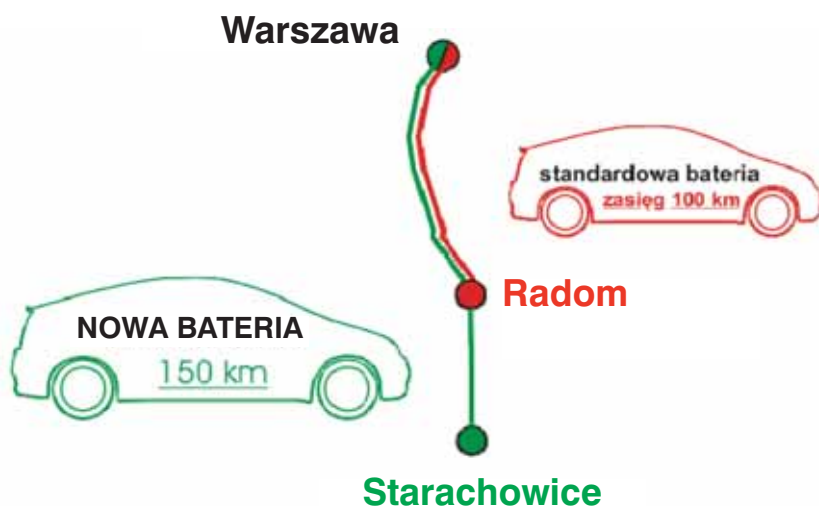
Zasięg samochodów elektrycznych zasilanych standardowym i nowym akumulatorem kwasowo-ołowiowym (rys. Szymon Obrębowski)
