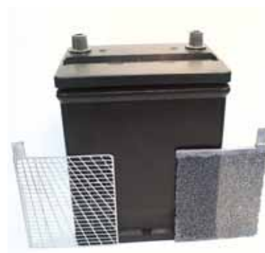
Z prawej strony wygląd stosowanego w nowym akumulatorze porowatego węgla szklanego, a z lewej tradycyjnej kratki ołowianej (fot. Jakub Lach, Kamil Wróbel)
